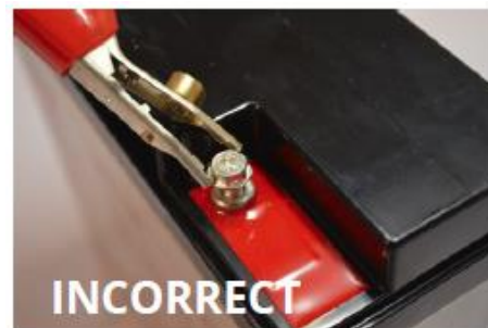
Anslut INTE till bultar med högt motstånd användande av inre monterade piggar
