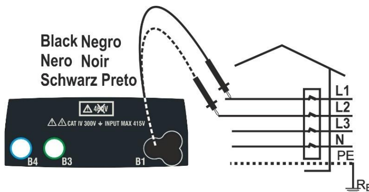
Fig. 31: Fasefølge test med prøveledninger
