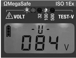
Anzeige der Ladespannung bei angeschlossenen externen Kapazitäten
