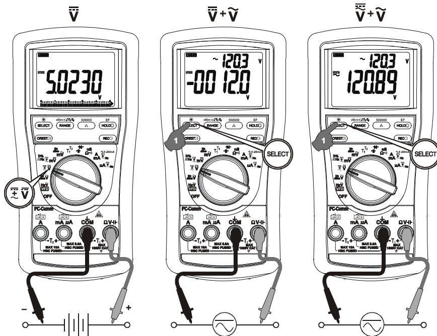
***DCmV, DCmV<sup>+ACmV</sup>, DC+ACmV<sup>+ACmV</sup>, Logiv Level HZ, Duty% funktioner***
