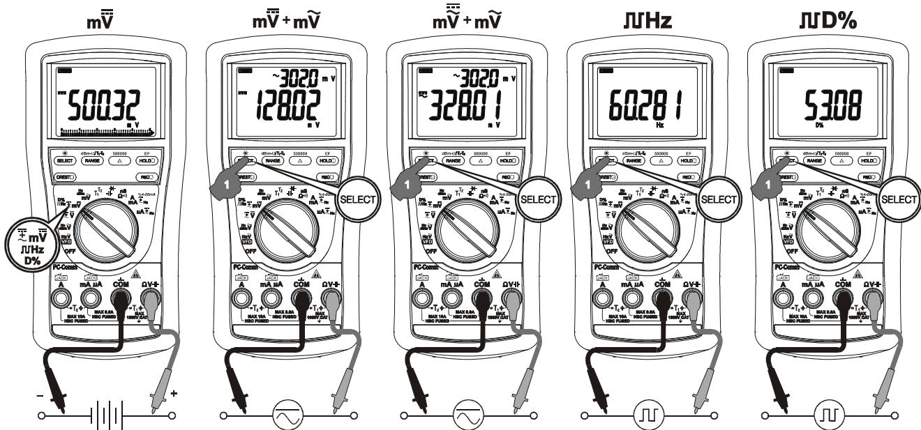
**$ACmV +Hz$ ,  $dBm +Hz$ ,  $Hz +ACmV$  functions**
