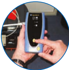
Autotest på remote enhet for enmanns betjening
