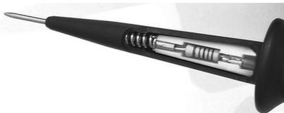
Hohe Sicherheit bietet das Gerät durch zwei Vorwiderstände unmittelbar hinter den beiden Prüfelektroden sowie zwei völlig unabhängige voneinander arbeitende Prüfsysteme:
