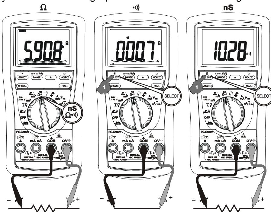
**ADVARSEL!** Ved brugen af gennemgangstest og modstandstest i et spændingsførende system, kan dette give fejlresultater og i værste fald ødelægge instrumentet. I mange tilfælde må den formodedt komponent frakobles fra systemet, for at man kan opne en præcis måling.
