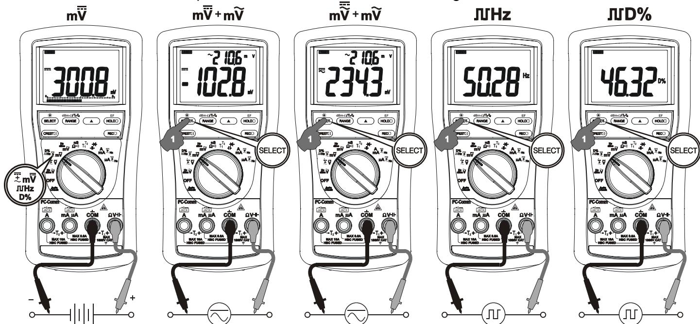
**ACmV+Hz, dBm+Hz (endast Elma 829), Hz+ACmV funktioner**Tryck på **SELECT**-knappen kortvarigt för att välja funktionerna sekvensvist. Det sista valda området kommer att bli sparat om instrumentet eventuellt stängs av.
