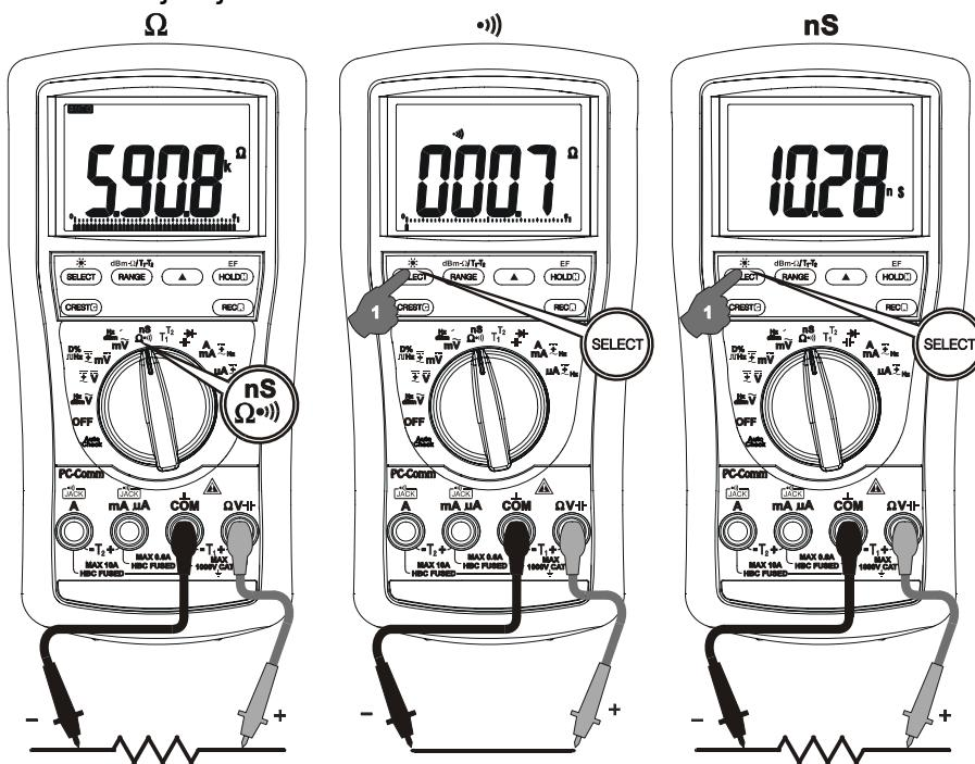
**VAROITUS!** Jos jatkuvuustestiä ja vastustestiä käytetään jännitteisessä järjestelmässä, laite voi antaa virheellisiä tuloksia ja pahimmassa tapauksessa vaurioitua. Useissa tapauksissa epäilty osa on irrotettava järjestelmästä tarkan mittaustuloksen saamiseksi.
