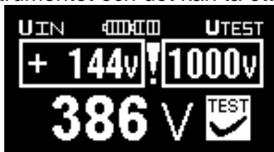
Fig. 3.10a Exempel på U_{SPD} mätresultat (urladdning pågår)
