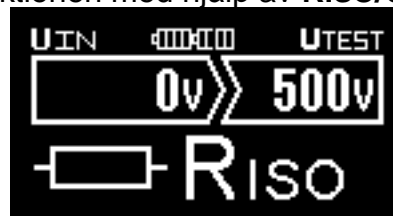
Fig. 3.5 Exempel på inställning för isolationsresistansmätning
