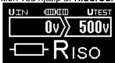
Fig. 3.5 Eksempel af opsætning for isolationsmodstandsmåling
