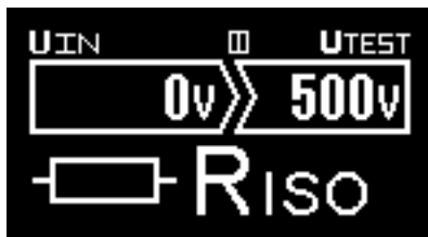
Fig. 3.2a Indikering av lågt batteri
