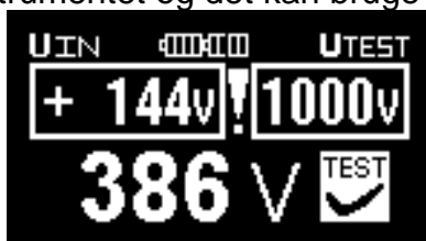
Fig. 3.10a Eksempel på U_{SPD} måleresultat (afladning/utlading er igangværende/pågående)
