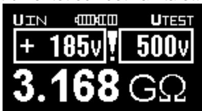
Fig. 3.7a Exempel på RISO mätresultat (Urladdning pågår)
