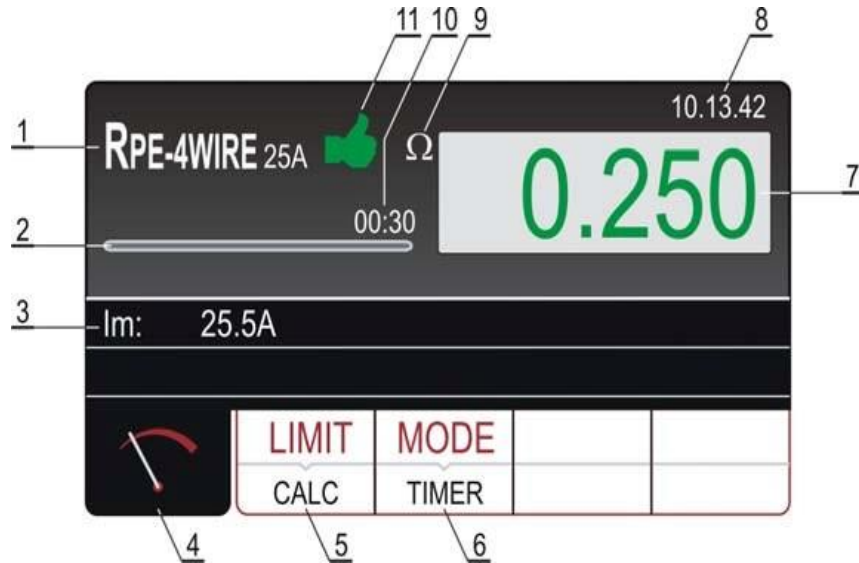
Figur 8: Display med et RPE-4WIRE testresultat.
