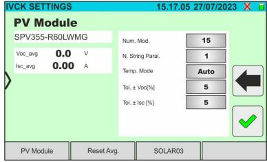
Fig. 48: IVCK test parameter settings
